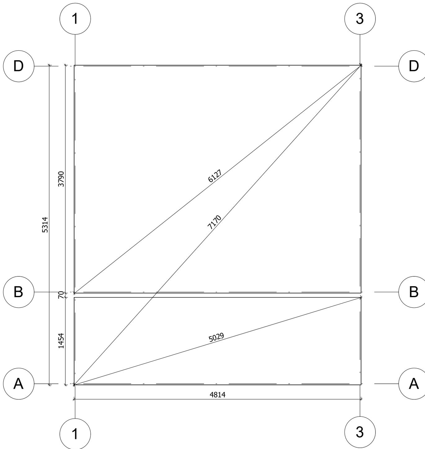
La fondation doit être réalisée conformément aux dimensions du plan pour parer tout désordre interne à la construction (infiltrations d'eau, déformations de la structure...) Nos projet doivent être montés sur une fondation plane avec une pente maximum de 10mm pour 10m.
